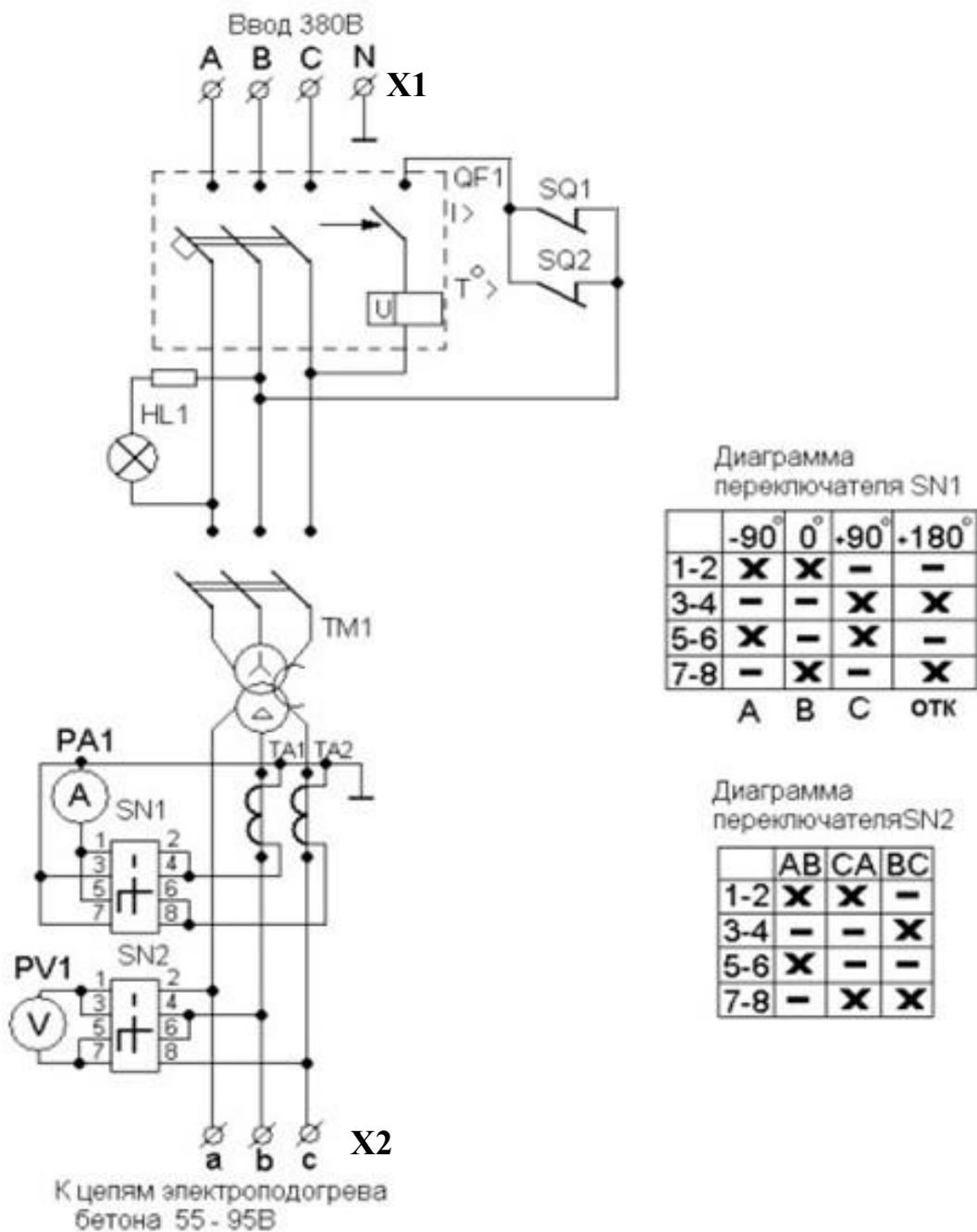
Перечень элементов к схеме электрической принципиальной
