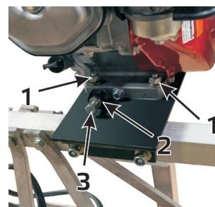
**! Натяжение приводного ремня проверяйте после первых 4 и через каждые 100 часов работы, в случае необходимости проводите регулировку.**
