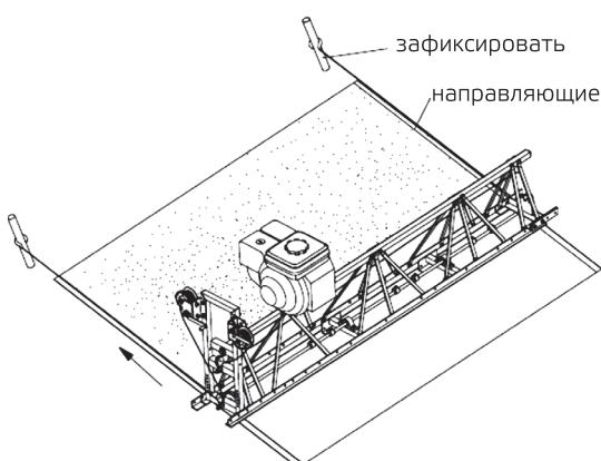
1. Запустите двигатель и прогрейте его. Выравнивание бетона осуществляется только при полном открытии дросселя.
